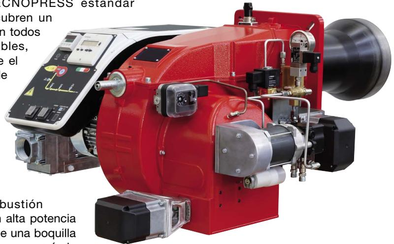
Están equipados con un cabezal de combustión diseñado para producir llamas de difusión con alta potencia de irradiación con respecto al lado del gas, y de una boquilla a reflujo que permite, gracias a un regulador que varía la presión de combustible en el retorno y, por lo tanto, en el flujo, de obtenga un rango de ajuste de 1:3 en la versión PR y MD.
