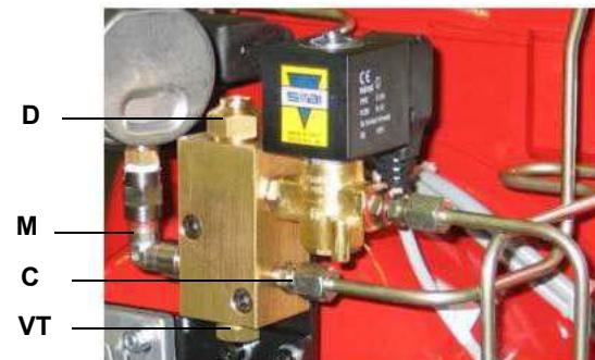
Рис. 29 - Ручной регулятор жидкого топлива
