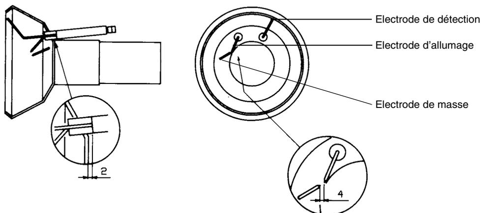
**Fig. 39 - Réglage de la position des électrodes P65**
