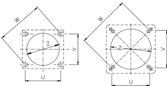
Fig. 1b - Gabarit de perçage plaque chaudière
