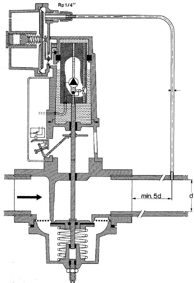
Dibujo facilitado por una válvula gas con servomotor y ajustador de presión incorporado.
