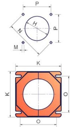
Рис. 2 - Схема для выполнения отверстия в плите котла
