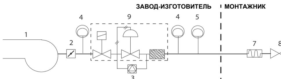
Rp2 - DN65 - DN80: Газовая рампa с группой клапанов VGD со встроенным стабилизатором давления газа + блок контроля герметичности VPS504
