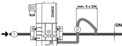
2 = Импульсная трубка
