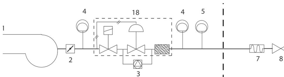
DN65 - DN80: Газовая рампa с группой клапанов MBC (2 клапана + газовый фильтр + стабилизатор давления + реле давления) + блок контроля герметичности VPS504
