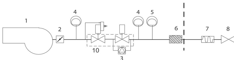
Rp2: Газовая рампa с группой клапанов MBC (2 клапана + газовый фильтр + стабилизатор давления + реле давления) + блок контроля герметичности VPS504
