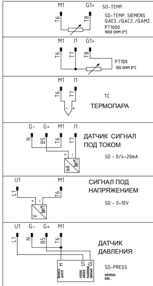
Рис. 21 - Схема подсоединения датчиков для модулирующих горелок
