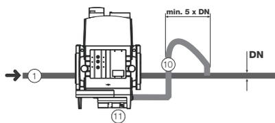
10 = Импульсная трубка
