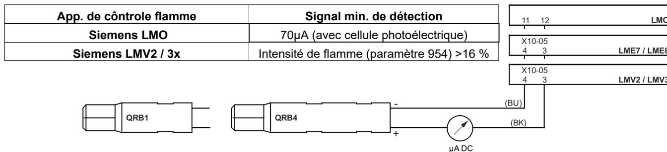
Fig. 9: Détection avec la cellule photoélectrique QRB4 - QRB1
