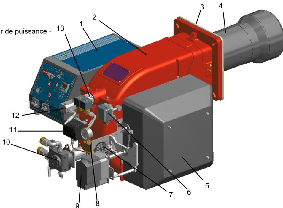
Le combustible, provenant du réseau de distribution, est envoyé par la pompe à la buse et de la buse à la chambre de combustion où il est mélangé à l'air de combustion et où la flamme se développe.
