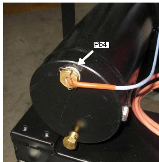
Fig. 15 - Conexiones de las sondas Danfoss MCX
