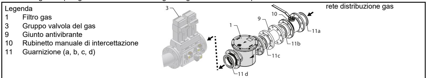
Montaggio corpo valvola sulla linea gas dedicata: per montare i gruppi valvole gas, sono necessarie 2 flange filettate o flangiate a seconda del diametro
