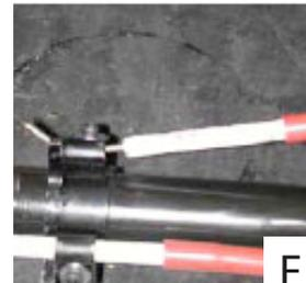
**Sostituzione dell'elettrodo di rilevazione (per bruciatori di gas naturale)**
