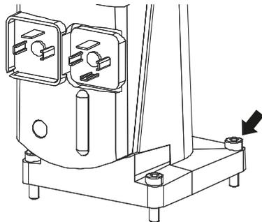
Per la sostituzione degli attuatori agire sulle viti come indicato nel disegno.
