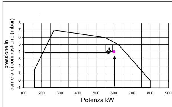
Tracciare, sul diagramma "Campo di lavoro" del bruciatore, una retta verticale in corrispondenza della potenza al focolare e una retta orizzontale in corrispondenza del valore di pressione di interesse. Il bruciatore è idoneo solo se il punto di intersezione "A" delle due rette, ricade all'interno del campo di lavoro.
