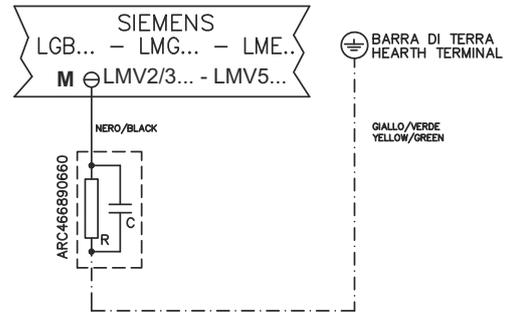
**Configurazione con quadro elettrico separato (optional)**
