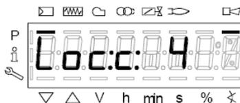
significa che il bruciatore è in **blocco (Lockout)** con codice errore (Error code): nell'esempio "Codice errore: 4". Verrà visualizzato alternato anche il messaggio
