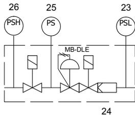
A seconda del tipo di bruciatore e della dimensione della rampa gas, le valvole MB-DLE sono fornite al posto delle VGD. In questo caso, l'elemento 42 è incluso nel gruppo valvole. Vedi lo schema seguente.
