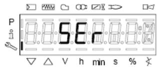
Le mode Service permet d'afficher des informations sur l'intensité de la flamme, la position des servocommandes, le nombre et les codes de blocage :
