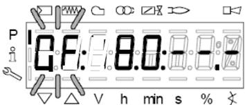
Pour régler l'angle d'ouverture du volet d'air « 0A » au point d'allumage (p. ex. à 10°, voir ci-après), appuyer simultanément sur les boutons « A » et « + » ou « - ».
