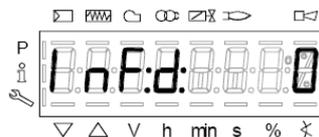
Pour réinitialiser, appuyez sur le bouton InFo pendant une seconde. Enregistrez les chiffres et vérifiez le type de panne dans le tableau des erreurs.
