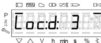
"Code de diagnostic" : dans l'exemple "Code de diagnostic : 3". Enregistrez les chiffres et vérifiez le type de panne dans le tableau des erreurs."
