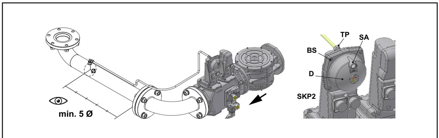
**Vannes gaz Siemens - Version avec SKP2 (stabilisateur de pression incorporé)**
