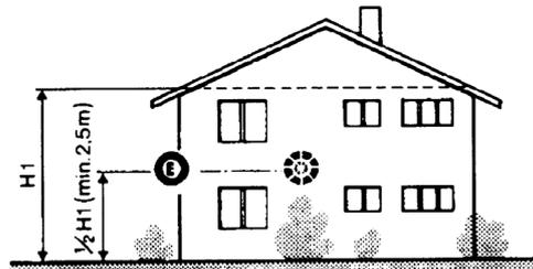
**Règle générale :** sur le mur extérieur du bâtiment correspondant aux pièces d'habitation, jamais sur la façade exposée au sud ou à un endroit exposé à la lumière du soleil du matin. En cas de doute, les placer sur la façade nord ou nord-ouest.
