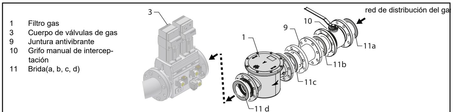
Montaje del cuerpo de válvula en la línea de gas: **para montar los grupos de válvulas de gas dobles, se necesitan 2 bridas con rosca o bridas según el diámetro;**
