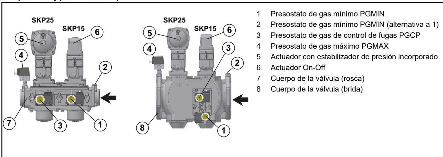
**Conexión del actuador SKP2... a la rampa de gas**
