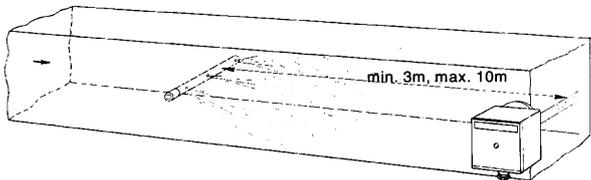
**Montaje de las sondas de presión**
