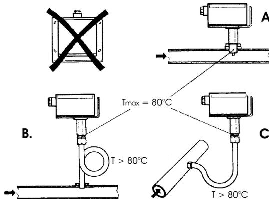
**Montaje de las sondas diferenciales para agua**
