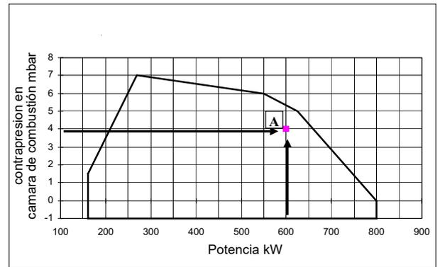
El quemador es idóneo solamente si el punto de intersección "A" de las dos rectas cae dentro del campo de trabajo. Los datos corresponden a condiciones estándares: presión atmosférica igual a 1013 mbar, temperatura ambiente igual a 15° C.
