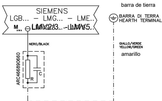
En el caso de quemadores equipados con LMV5x, consultar las indicaciones del cableado del sistema, suministradas por Siemens en el CD adjunto
