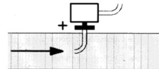
**Conexión sonda de presión Siemens QBE2...P...**
