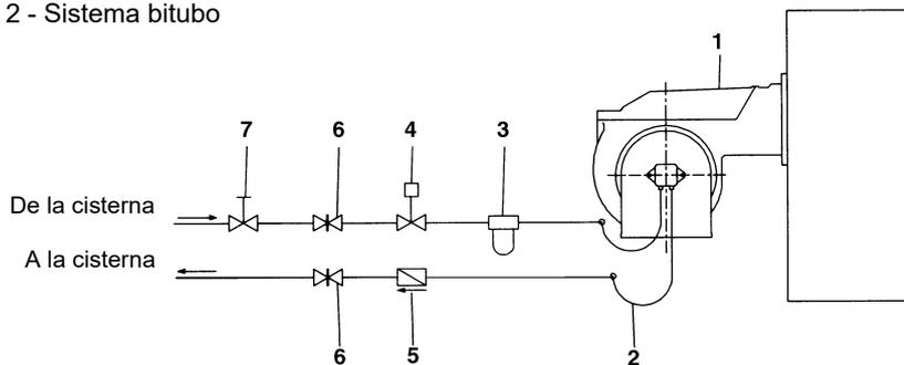
El suministro preve el filtro y los flexibles, toda la parte ante del filtro y la parte despues del latiguillo de retorno, tiene que ser predispueta por el usuario. Por la conexión de los flexibles, consultar el relativo párrafo.
