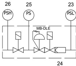
Según el tipo de rampa gas y el tipo de quemador, válvulas de seguridad MB-DLE se suministran. En este caso, el elemento 42 está integrado en las válvulas.
