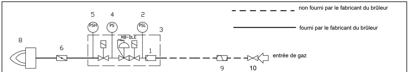
Rampe gaz avec groupe vannes VGD avec stabilisateur de pression gaz incorporé+ contrôle d'étanchéité VPS504
