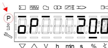
Le tiret en regard du symbole « P » (en surbrillance sur la figure) disparaît, ce qui indique que l'appareil est sorti du mode programmation. Le brûleur fonctionne désormais automatiquement, en suivant la courbe réglée.
