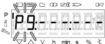
Procéder de la même manière que celle décrite ci-dessus pour le réglage des valeurs d'ouverture des servocommandes d'air (**A**) et de combustible (**F**) et éventuellement du variateur (**F + A**) pour le LMV37.
