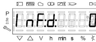
Pour réinitialiser, appuyez sur le bouton InFo pendant une seconde. Enregistrez les chiffres et vérifiez le type de panne dans le tableau des erreurs.
