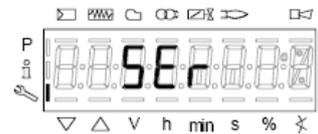
Le niveau Service vous permet d'afficher des informations sur l'intensité de la flamme, la position du servo, le numéro et les codes de verrouillage :
