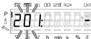
Dans l'exemple, inclure la configuration : **1** = Allumage direct au gaz (G mod).
