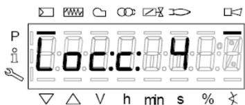
signifie que le brûleur est en verrouillage avec un code d'erreur : dans l'exemple "Code d'erreur : 4". Le message
