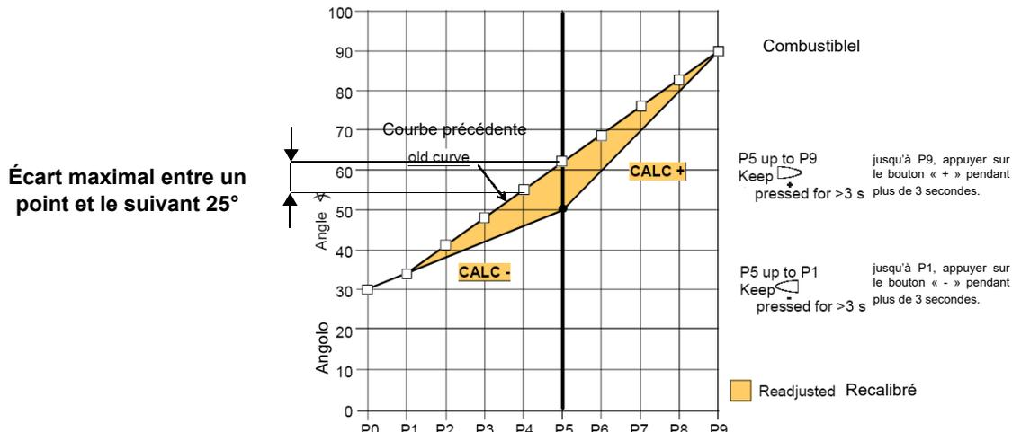
12 Appuyer sur le bouton « - » pour descendre à tous les points inférieurs jusqu'à P0 et vérifier la combustion, changer les points comme décrit précédemment.
