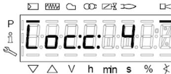
Cela signifie que le brûleur est en **Blocage (Lockout)** avec un code d'erreur du type « Error code : 4 ». Un message de code de diagnostic s'affiche également en alternance p. ex. « Diagnostic code : 3 ».
