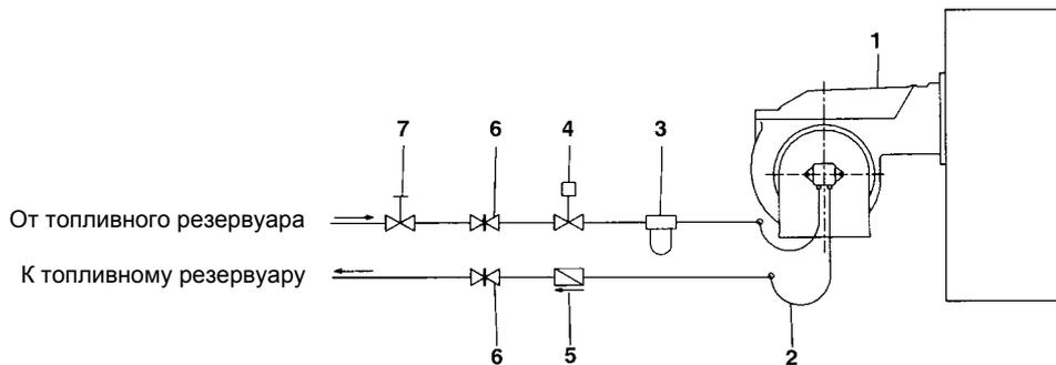
Рис. 5 - Двухтрубная система
