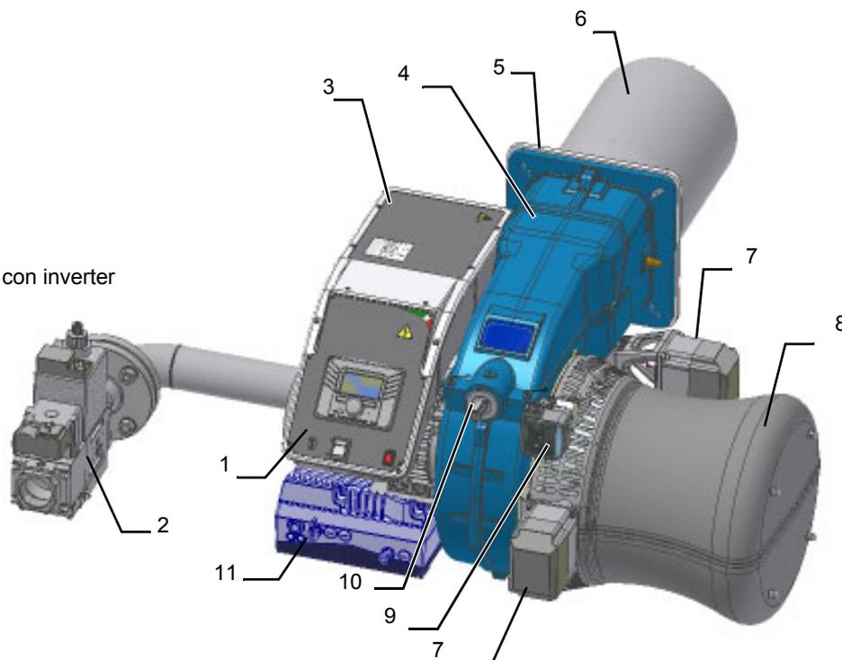
**Funzionamento a gas:** il gas, proveniente dalla rete di distribuzione, passa attraverso il gruppo valvole, complete di filtro e stabilizzatore. Quest'ultimo mantiene la pressione nei limiti di utilizzo. I servocomandi, agiscono modo proporzionale sulle serrande di regolazione della portata dell'aria comburente e sulla valvola a farfalla del gas, consentendo di ottimizzare i valori del gas di scarico e, quindi, di ottenere un'efficace combustione.
