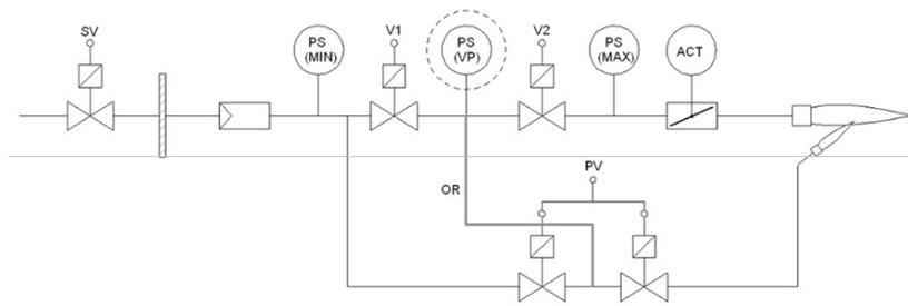
Fig. 17. VPS tempo di pressione atmosferica (gas pilota)
