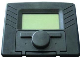
Da display Bruciatore RC21.52 è possibile impostare alcuni parametri di funzionamento Inverter in abbinata al Bruciatore.
