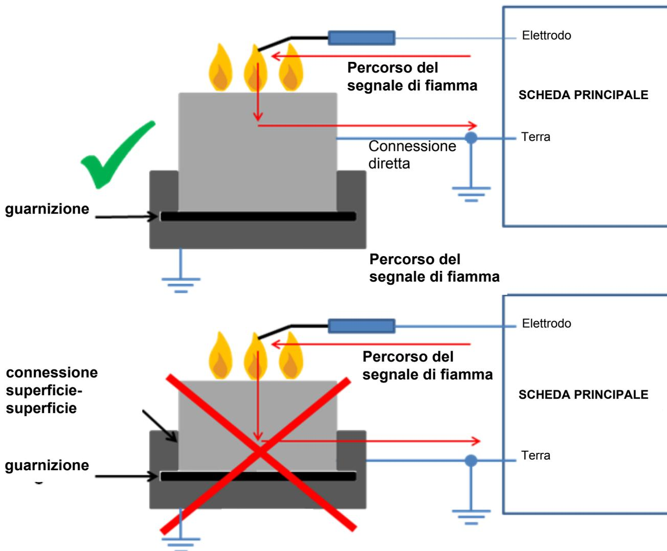
Fig. 9. Raccomandazione sul percorso del segnale di fiamma
