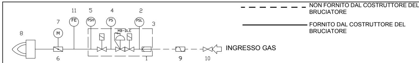
Rampa con gruppo valvole VGD con stabilizzatore di pressione gas incorporato + pressostato gas controllo perdite (PGCP)
