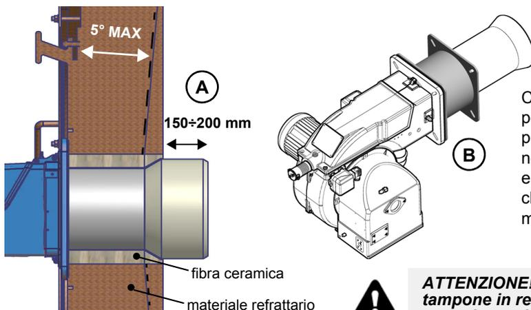
Caldaie a tre giri di fumo (con il primo giro fumi nella parte posteriore): il boccaglio deve entrare in camera di combustione per almeno 150±200 mm (Fig. A). La lunghezza dei boccagli non sempre soddisfa questo requisito, pertanto potrebbe essere necessario utilizzare un distanziale di misura adeguata, che serve a far arretrare il bruciatore in modo da soddisfare le misure di cui sopra (Fig. B).
