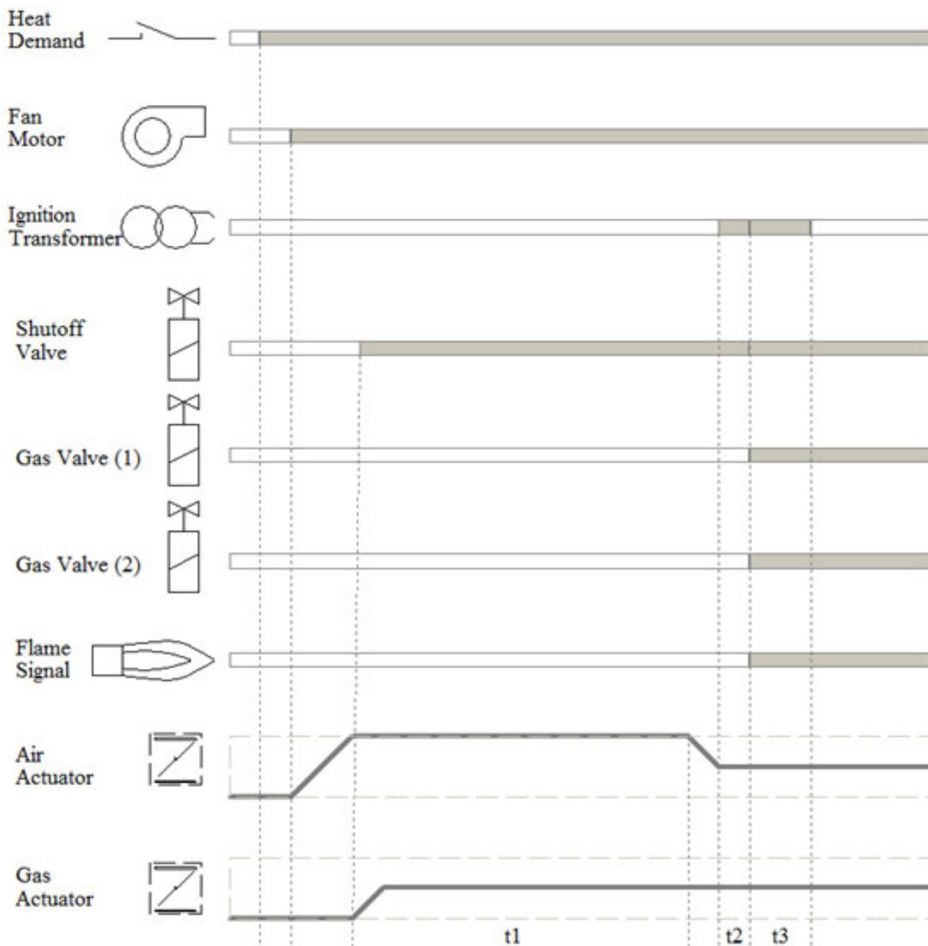
Fig. 11. Sequenza di avvio del bruciatore (Accensione diretta – VPS disattivato)
