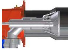
Posición del cabezal "MÁX"
