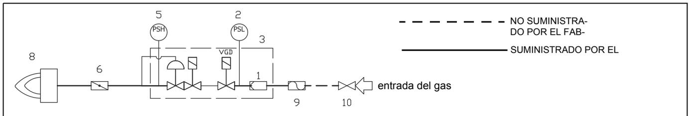
Rampa gas con grupo válvulas MB-DLE (2 válvulas + filtro gas + estabilizador de presión gas + presostato) + presostato gas control de estanqueidad (PGCP)
