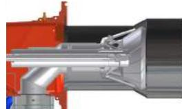
Posición del cabezal "MIN"
