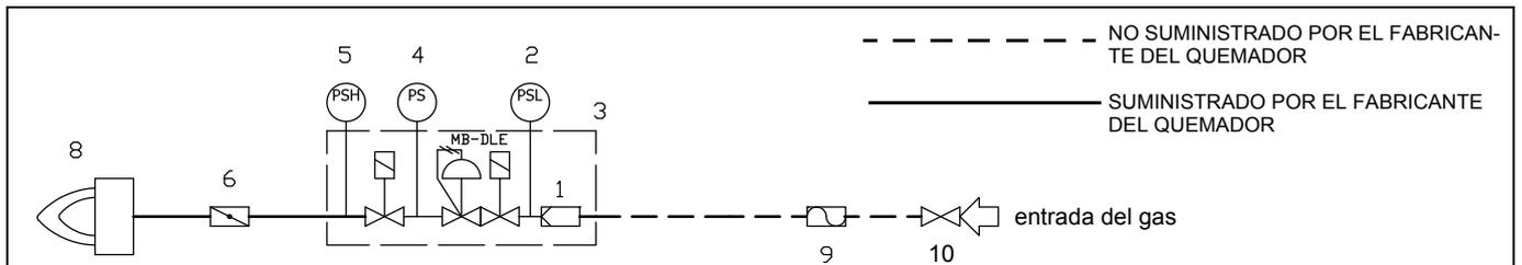
Rampa gas con grupo válvulas VGD y MBE con estabilizador de presión gas incorporado + presostato gas control de estanqueidad (PGCP)
