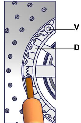
El disco se debe regular durante la puesta en funcionamiento de la instalación.
