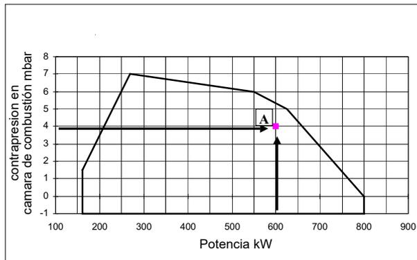
El quemador es idóneo solamente si el punto de intersección "A" de las dos rectas cae dentro del campo de trabajo. Los datos corresponden a condiciones estándares: presión atmosférica igual a 1013 mbar, temperatura ambiente igual a 15° C.
