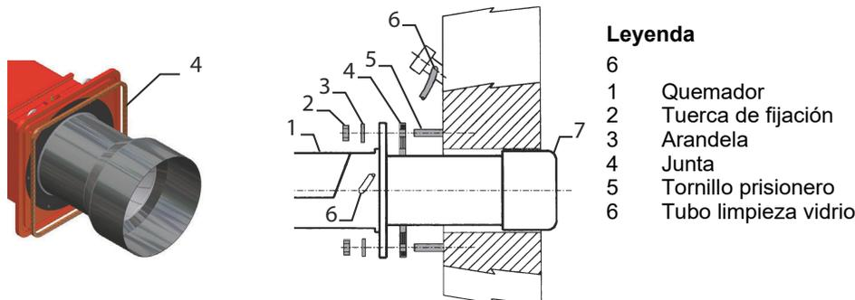
El quemador nace para funcionar situado según la figura indicada bajo. Por instalaciones diferentes, se ruega contactar el despacho técnico.
