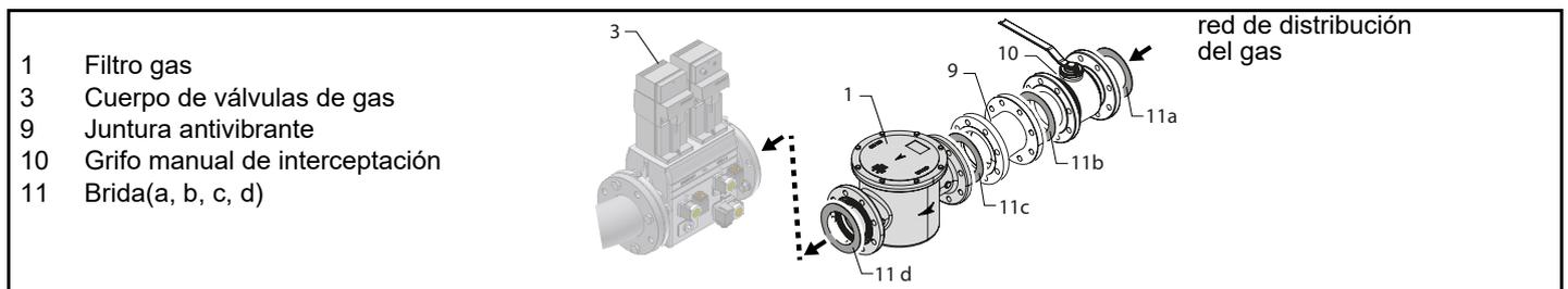
Montaje del cuerpo de válvula en la línea de gas: **para montar los grupos de válvulas de gas dobles, se necesitan 2 bridas con rosca o bridas según el diámetro;**
