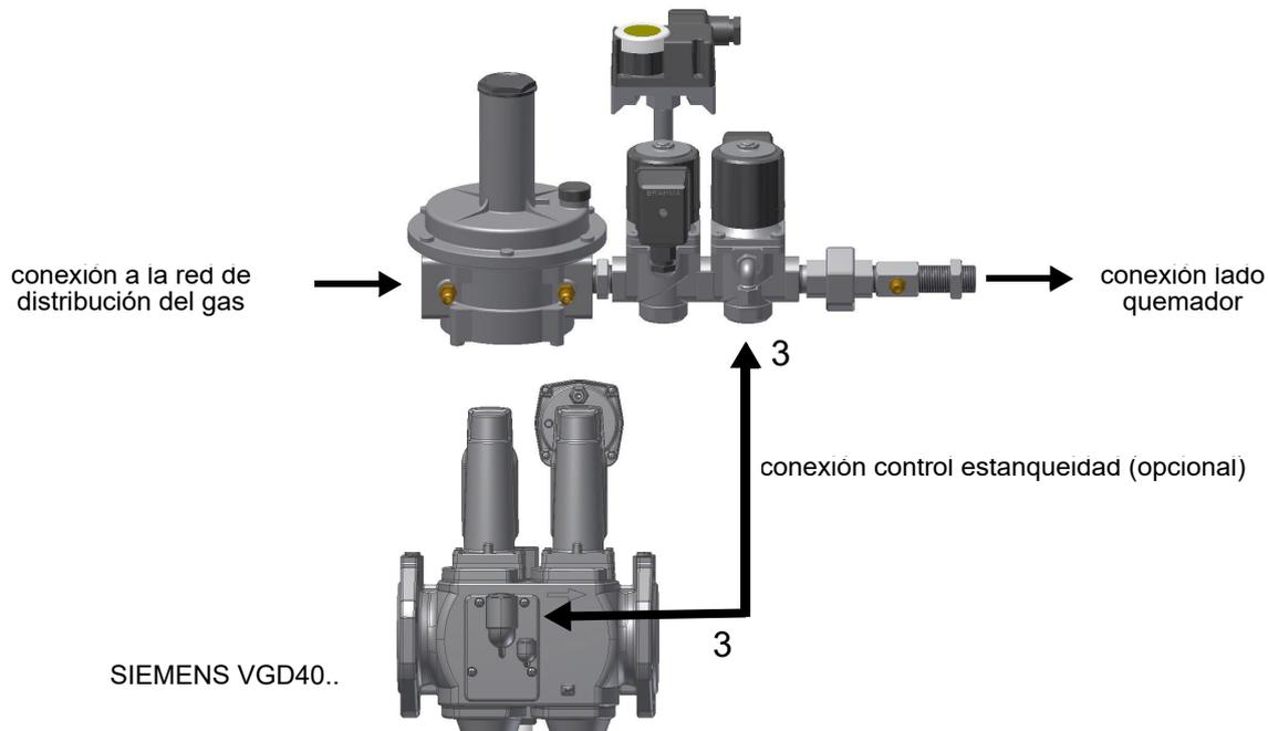
**A continuación se describen los procedimientos de instalación de los grupos de válvulas utilizados en las diferentes rampas.**
