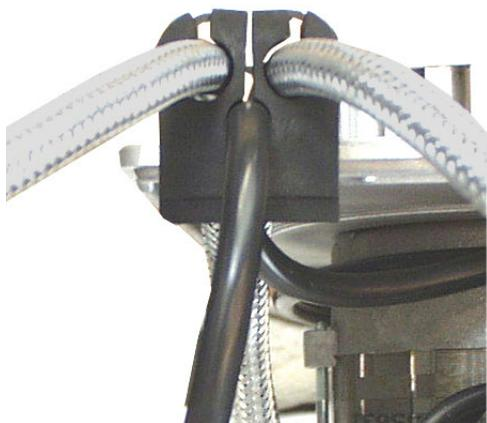
Rimontare la piastrina fermacavi **C**. Infilare il gommino nell'apposita sede nella coclea del bruciatore; fissare le viti **V**.
