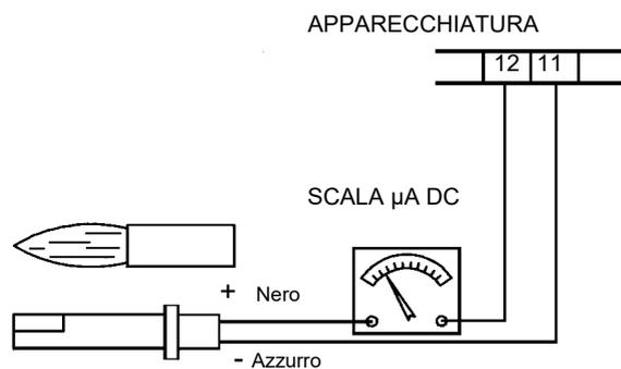
Fig. 16: Rilevazione con fotocellula QRB4
