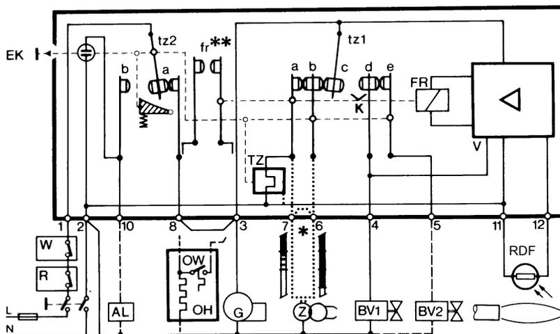
Le apparecchiature di controllo fiamma LMO... sono progettate per l'avviamento e il controllo di bruciatori a gasolio mono o bistadio con tiraggio forzato, a funzionamento intermittente. Le fiamme gialle vengono controllate dai rivelatori a fotoresistenza QRB..., le fiamme blu dai rivelatori QRC...
