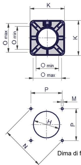
Dima di foratura piastra caldaia
