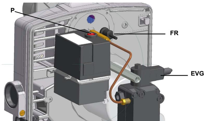
La portata del gasolio è stata determinata scegliendo un ugello di dimensione adeguata alla potenza della caldaia/utilizzo, tarando la massima pressione di mandata della pompa (vedi schema di principio del circuito gasolio in ). Per la scelta dell'ugello si fa riferimento alla (\*); per la regolazione della pressione della pompa si deve utilizzare la vite di regolazione indicata al paragrafo pagina 14. Ulteriori informazioni sono riportate al paragrafo "Utilizzo delle pompe".
