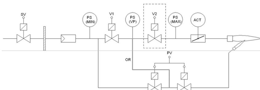
Fig. 16. VPS Tempo di evaquazione (gas pilota)
