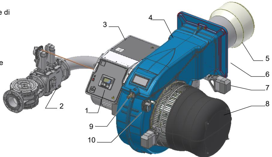
**Funzionamento a gas:** il gas, proveniente dalla rete di distribuzione, passa attraverso il gruppo valvole, complete di filtro e stabilizzatore. Quest'ultimo mantiene la pressione nei limiti di utilizzo. I servocomandi, agiscono modo proporzionale sulle serrande di regolazione della portata dell'aria comburente e sulla valvola a farfalla del gas, consentendo di ottimizzare i valori del gas di scarico e, quindi, di ottenere un'efficace combustione.
