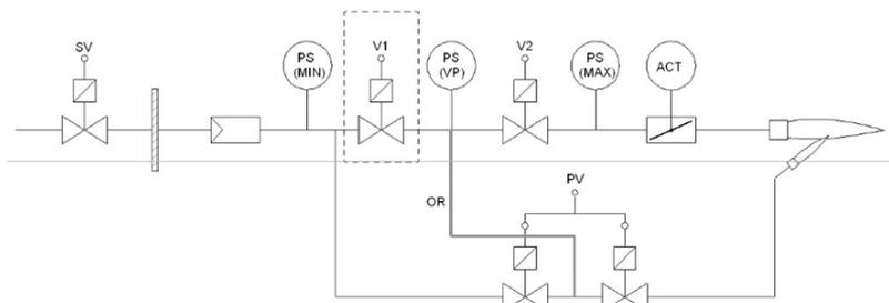
Fig. 18. VPS Tempo di riempimento (gas pilota)
