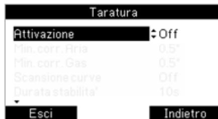
Fig. 3. RC21 display: attivazione della taratura
