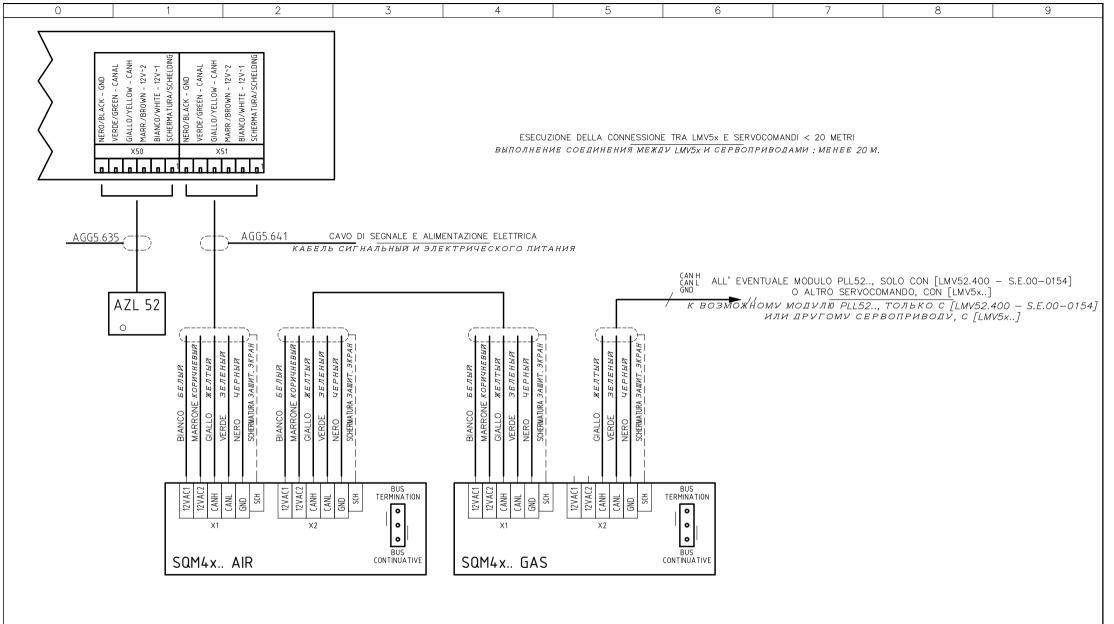
LA SEQUENZA DEI SERVOCOMANDI PUO' ESSERE DIVERSA; E' IMPORTANTE PERO' CHE L'ULTIMO SIA LA SCHEDA "PLL52..." ПОСЛЕДОВАТЕЛЬНОСТЬ СЕРВОПРИВОЛОВ МОЖЕТ БЫТЬ ИНОЙ; THE LAST COMPONENT MUST BE THE "PLL52..." CIRCUIT
