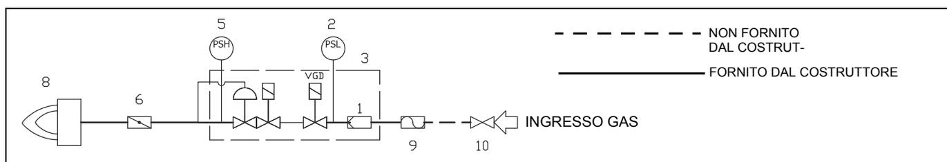
Rampa con gruppo valvole MB-DLE (2 valvole + filtro gas + stabilizzatore di pressione + pressostato) + pressostato gas controllo perdite (PGCP)
