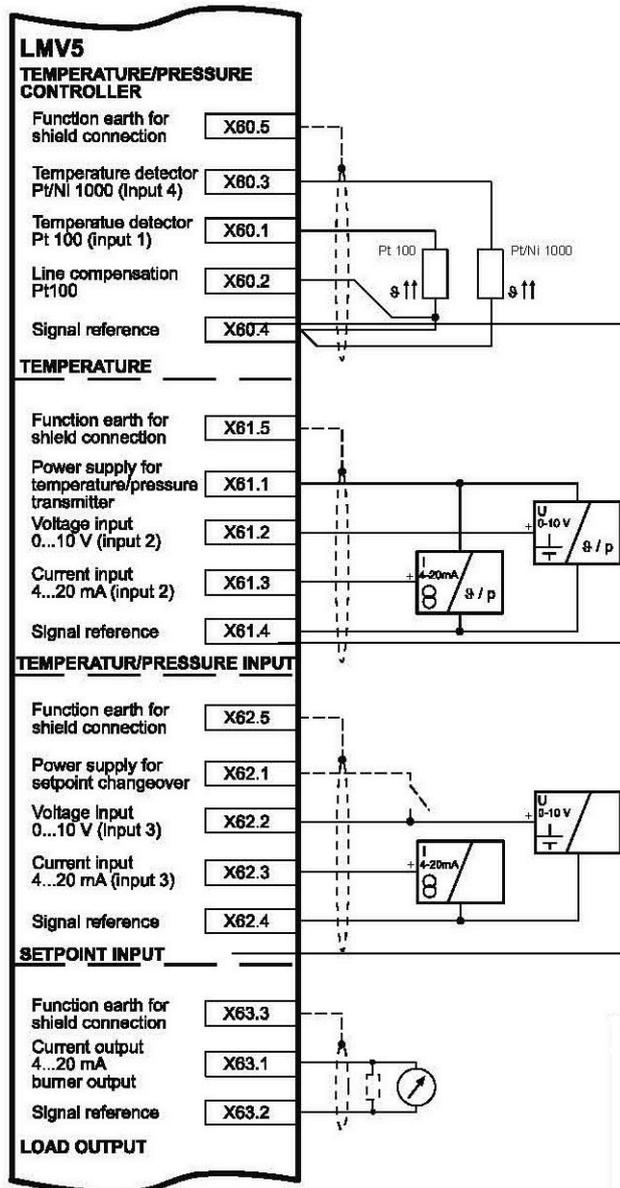
Blocco X60 utilizzato per la scelta IntLC... (utilizzo sensore di temperatura)
