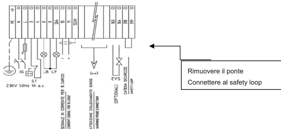
**NOTA:** Quando safety loop apre, il bruciatore si spegne immediatamente, saltando la fase di bassa fiamma. E' importante distinguere la "serie termostatica" da "safety loop"
