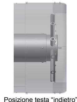
A seconda dell'applicazione, è possibile agire sui fori (figura B) per migliorare la stabilità di fiamma e i valori di emissione NOx, CO. Se necessario, chiudere/aprire i fori della figura B utilizzando il kit viti dato a corredo del bruciatore.
