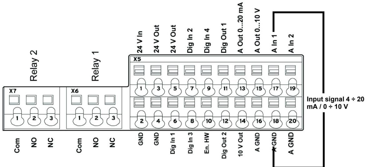
L'ingresso AI1 può essere configurato come ingresso in tensione o corrente per LMV5-Etamatic viene configurato come ingresso in corrente 4-20mA, per LMV2x/3x come ingresso in tensione 0-10V.
