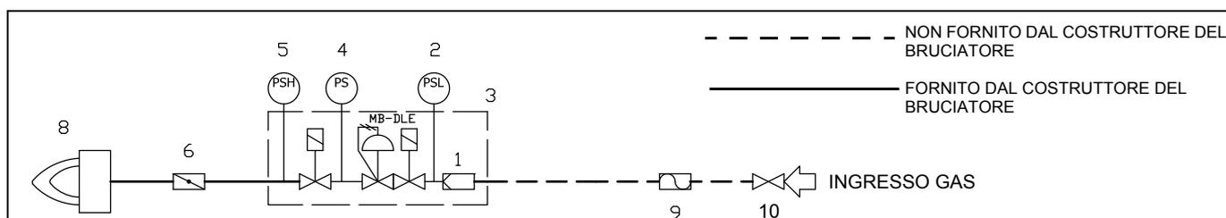
MBERampa con gruppo valvole VGD e MBE con stabilizzatore di pressione gas incorporato + pressostato gas controllo perdite (PGCP)
