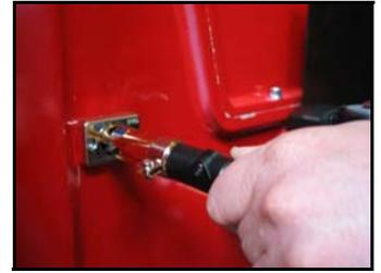
**Misura della corrente di rilevazione**
