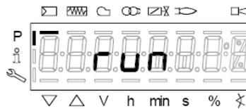
El quemador está listo para funcionar. En este punto hay que seleccionar los puntos de la curva, en base a los valores de combustión , pulsando la tecla “enter”
