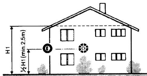
**Regla general::** en las paredes externas de la sala de estar del edificio. Jamás en la zona dirigida al sur o en posición de ser expuesta a las irradiaciones solares de la mañana. En caso de duda colocarla en el lado norte o noroeste..
