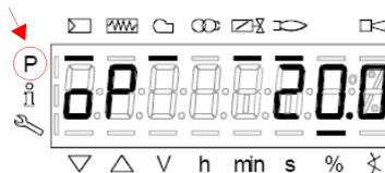
El guión a la altura del símbolo "P" (destacado en la figura) desaparecerá, lo que indica que la unidad ha salido de la programación. El quemador funcionará, por tanto, en modo automático, siguiendo la curva configurada.
