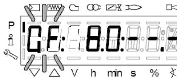
Si queremos imponer la clapeta del aire "0A" en el punto de encendido ( por ejemplo a 10° - Véase mas adelante) pulse "A" Y al mismo tiempo "+" o "-"
