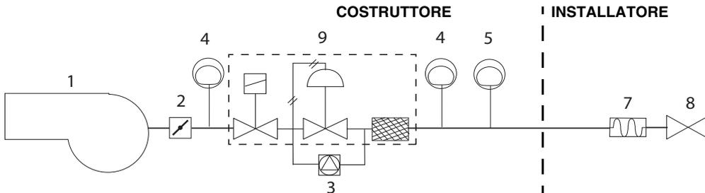
Rp2 - DN65 - DN80: Rampa con gruppo valvole VGD con stabilizzatore di pressione gas incorporato + controllo di tenuta VPS504.
