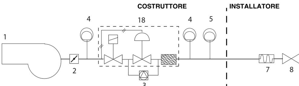
DN65 - DN80: Rampa con gruppo valvole MBC (2 valvole + stabilizzatore di pressione) + controllo di tenuta VPS504 + filtro gas
