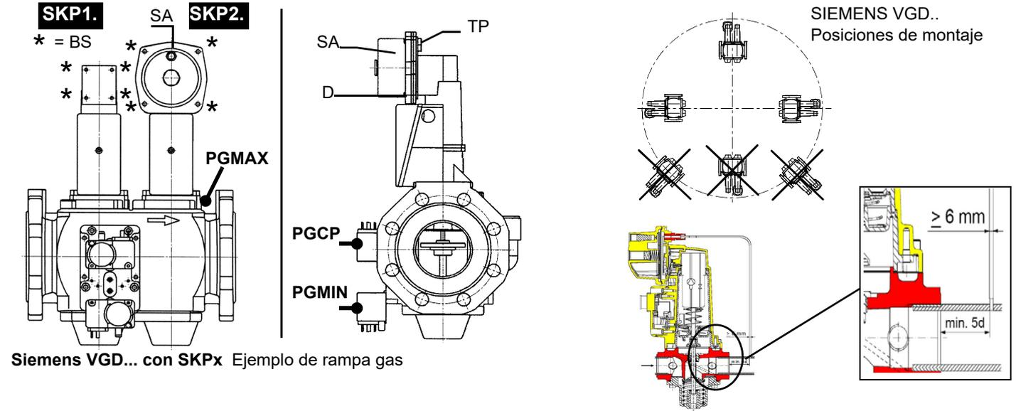
Siemens VGD... con SKPx Ejemplo de rampa gas
