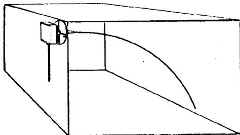
Curvar a mano (jamás con un instrumento) la sonda de 0,4 m, como indicado en la figura..
