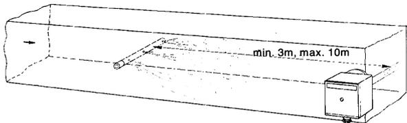
**Montaje de las sondas de presión**
