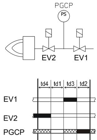
Si todas las fases antes enumeradas son realizadas con éxito, la prueba de estanqueidad puede considerarse concluida de forma positiva. De lo contrario, se producirá un bloqueo del quemador. Para LMV5x, LMV2x/3x y LME73 (excepto para LME73.831BC), el control de estanqueidad puede ser configurado de modo que se produzca en el encendido, apagado o ambos.
