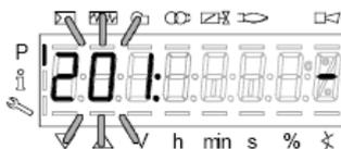
En este ejemplo vamos a utilizar la configuración: 1: Encendido directo gas (G mod).
