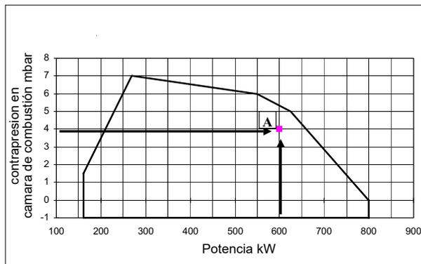
Trazar, en el diagrama "Campo de trabajo" del quemador una recta vertical en correspondencia con la potencia del fuego y una recta horizontal en correspondencia con el valor de presión que interesa. El quemador es idóneo solamente si el punto de intersección "A" de las dos rectas cae dentro del campo de trabajo. Los datos corresponden a condiciones estándares: presión atmosférica igual a 1013 mbar, temperatura ambiente igual a 15° C.
