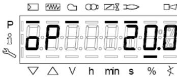
Cuando el generador haya alcanzado el set-point configurado, el quemador entrará en stand-by: la pantalla visualizará
