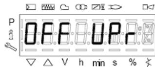
Esto significa que el regulador no ha sido nunca programado o que no se ha ajustado un tipo de funcionamiento (rampas de combustible) o que no ha sido configurada completamente
