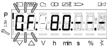
Si queremos imponer la clapeta del aire "0A" en el punto de encendido ( por ejemplo a 10° - Véase mas adelante) pulse "A" Y al mismo tiempo "+" o "-"
