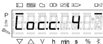
significa que el quemador está **bloqueado (Lockout)** con código de error (Error code): en el ejemplo “Código error: 4”. También se visualizará de forma alternada el mensaje
