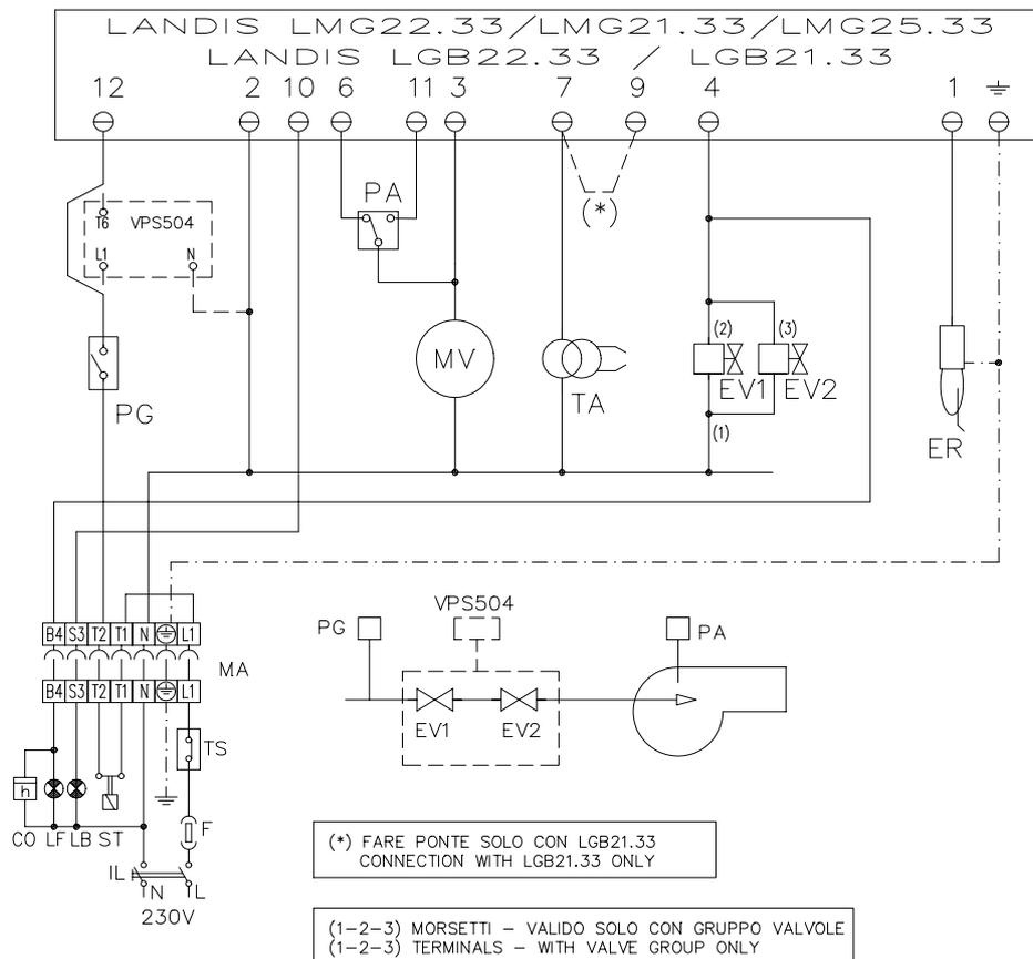
**Esquema eléctrico cod. 01-324/2 - Quemadores tipo S5 - S10 - S18**
