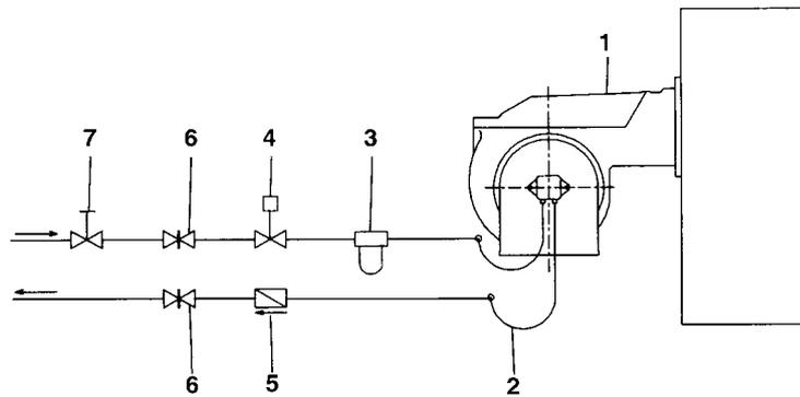
Fig. 3 - Sistema bitubo
