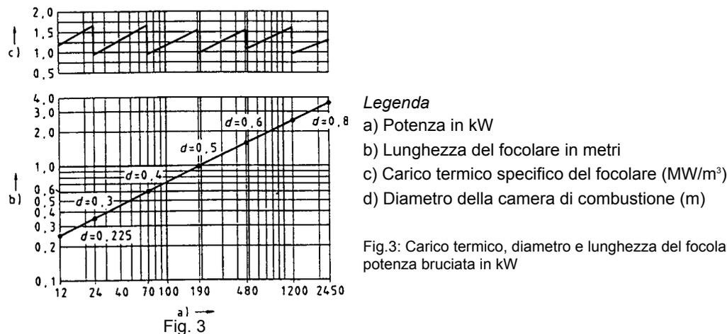
Fig.3: Carico termico, diametro e lunghezza del focolare di prova in funzione della potenza bruciata in kW
