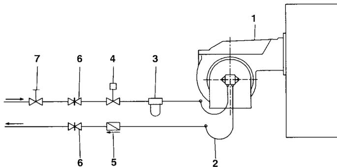
Fig. 4 - Sistema bitubo
