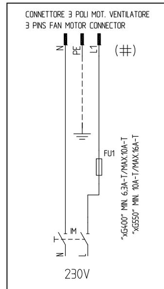
Fig. 29 - Connettore 3 poli motore elettrico per NG/LG/NGX400
