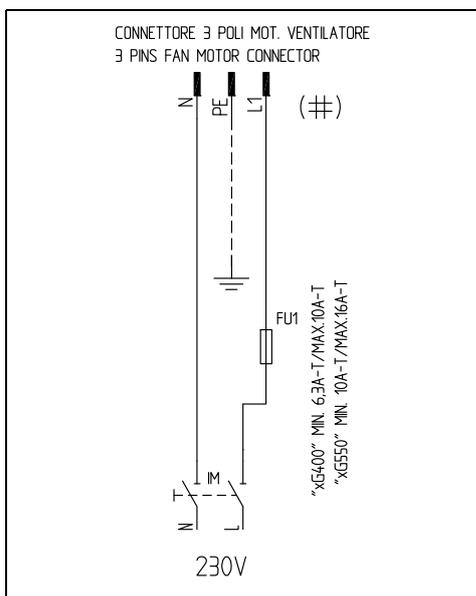
Fig. 33 - Connettore 3 poli motore elettrico per NG/LG/NGXG400
