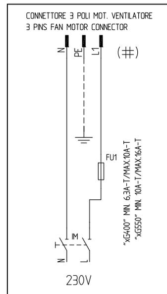
Fig. 31 - Connettore 3 poli per motore elettrico NG/LG/NGX400
