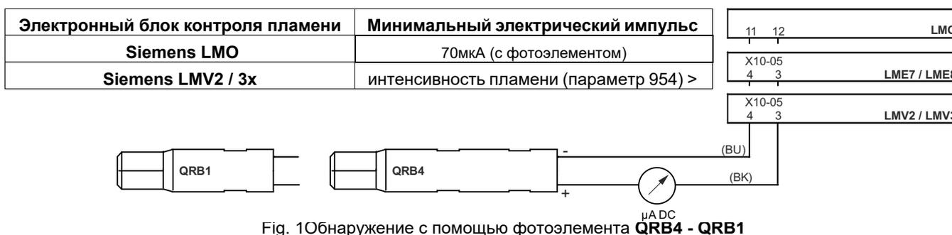
Fig. 10 Обнаружение с помощью фотоэлемента QRB4 - QRB1
