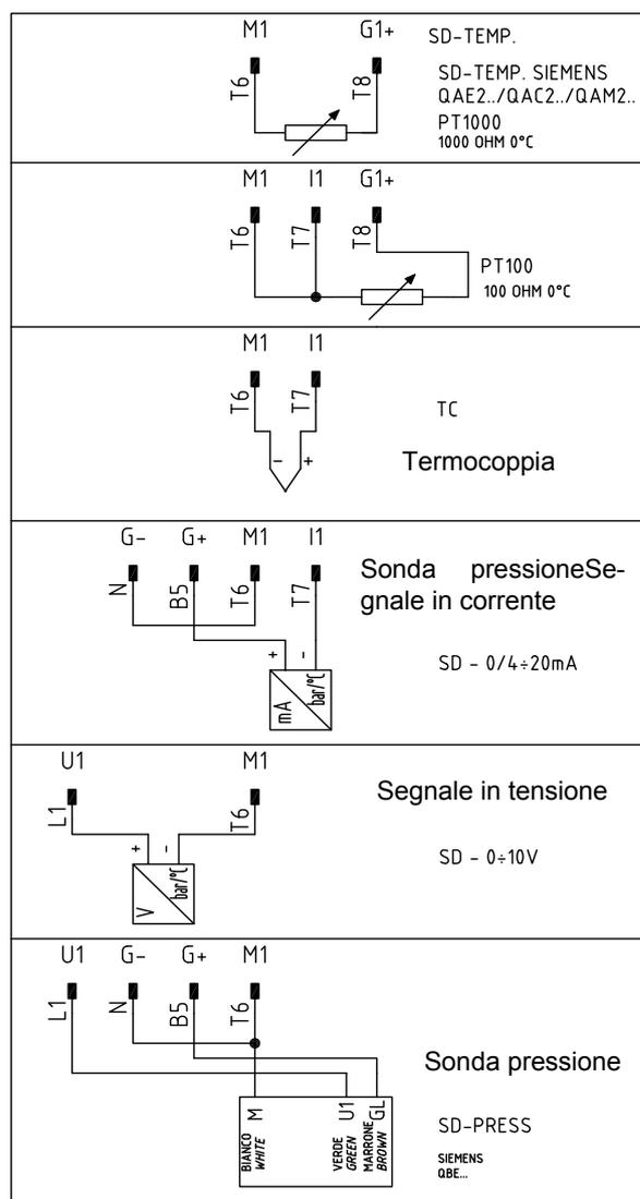
Fig. 4 - Collegamento sonde
