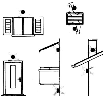
Evitare montaggi in prossimità di finestre, griglie di areazione, all'esterno del locale caldaia, sui camini o protetta da balconi, tettoie.
