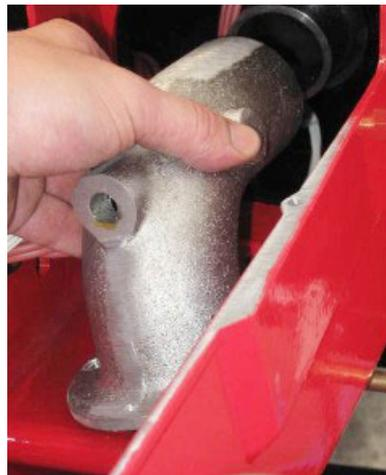
**⚠ ATTENZIONE:** nel rimontare il collettore ricordarsi di inserire l'anello "O". Durante la fase di centraggio delle teste, non fissare completamente le viti alla base del collettore. Fissarle dopo il centraggio. Non toccare le viti della cerniera e della flangia del bruciatore.
