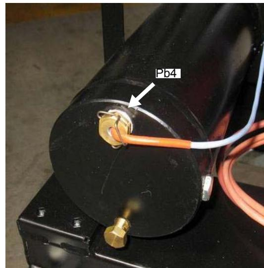
Fig. 28 - Collegamenti sonde Danfoss MCX
