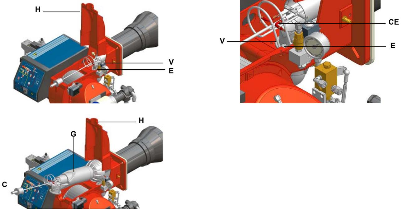
**Regulación de la posición de los electrodos y de la boquilla**
