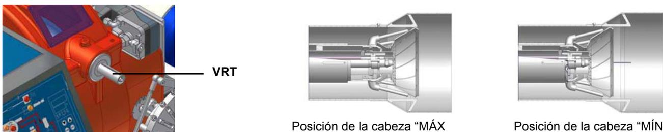
**Atención:** si se modifica la posición de la cabeza, repetir las regulaciones de aire y gas descritas en los puntos anteriores.
