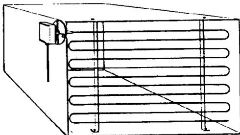
Disponer de toda la sección del canal, distancia mínima de las paredes 50mm, rayo de curvatura 10mm para las sondas de 2 o 6 m.
