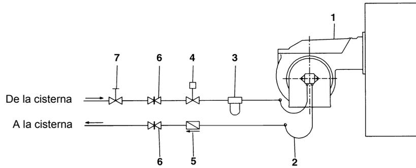
Fig. 22 - Sistema bitubo
