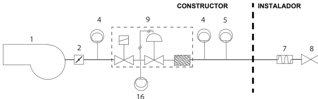
Rampa gas con grupo válvulas VGD20/40 con estabilizador de presión gas incorporado + control de estanqueidad VPS504
