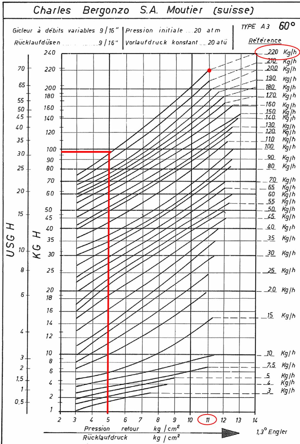
**Ejemplo:** si se tiene una boquilla Bergonzo, con caudal de 220 kg/h, se regula la presión máxima en el retorno a 11 bar, alimentando a 20 bar en descarga: se obtiene un caudal de 220 kg/h. En cambio, si la presión de retorno que se desea es de 5 bar, se debe intervenir en el tornillo de regulación del regulador de presión (véase Fig. 37).
