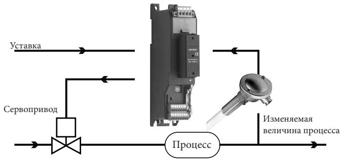
ПРИМЕР УПРАВЛЕНИЯ ДЛЯ КЛАПАНА V0
