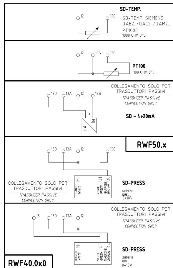
Соответствия клемм между модуляторами RWF50.2 и RWF40.0x0
