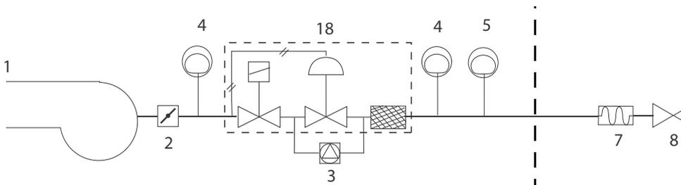
DN65 - DN80: Rampa gas con grupo válvulas MBC (2 válvulas + filtro gas + estabilizador de presión gas + presostato) + control de estanqueidad VPS504
