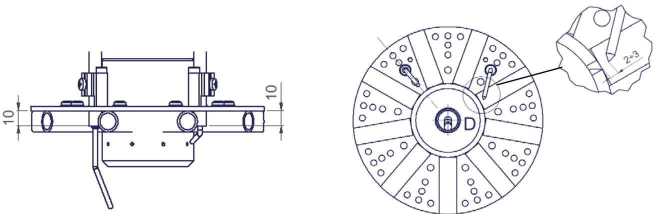
**Sustitución de los electrodos**
