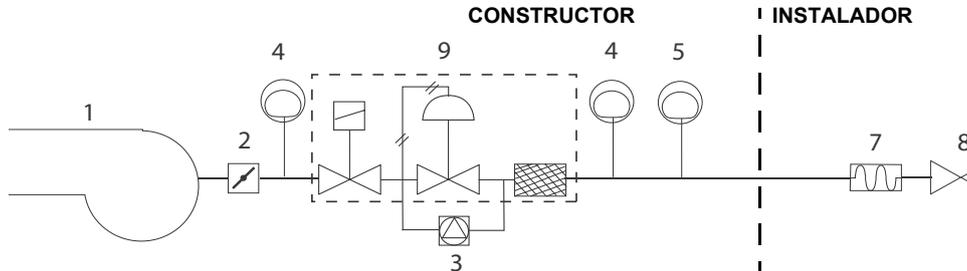
Rp2 - DN65 - DN80: Rampa gas con grupo válvulas VGD con estabilizador de presión gas incorporado + control de estanqueidad VPS504
