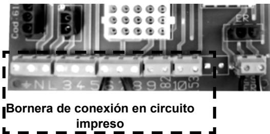
Bornera de conexión en circuito impreso
