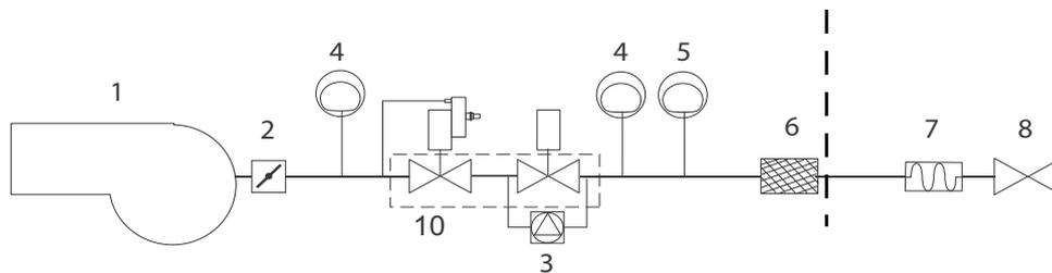
Rp2: Rampa gas con grupo válvulas MBC (2 válvulas + filtro gas + estabilizador de presión gas + presostato) + control de estanqueidad VPS504
