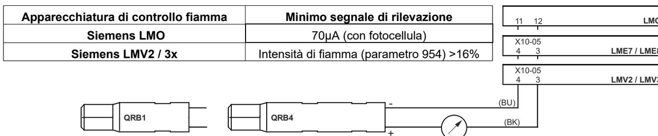
Fig. 1: Rilevazione con fotocellula QRB4 - QRB1
