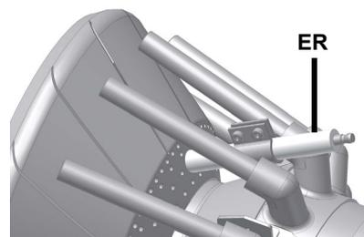
**Control de la corriente de detección con electrodo (Gas natural)**
