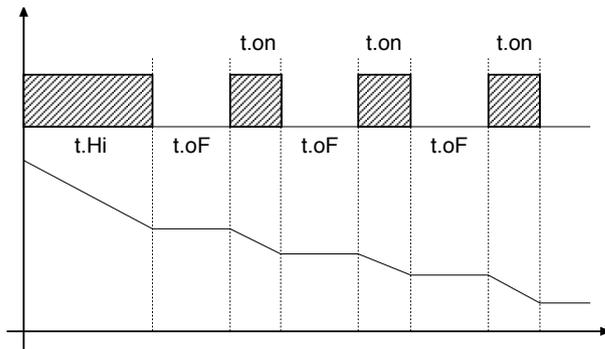
Si  $t.oF = 0$  se mantiene el funcionamiento corriente.
