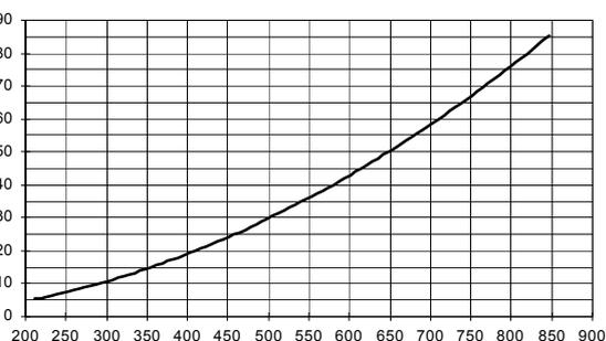
**Curvas de presión - caudal en cabezal de combustión (LPG)**
