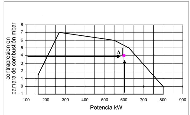
Trazar, en el diagrama "Campo de trabajo" del quemador una recta vertical en correspondencia con la potencia del fuego y una recta horizontal en correspondencia con el valor de presión que interesa.
