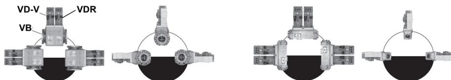
**Posiciones de montaje MBE / VB / VDMontaje VD-R & PS...**
