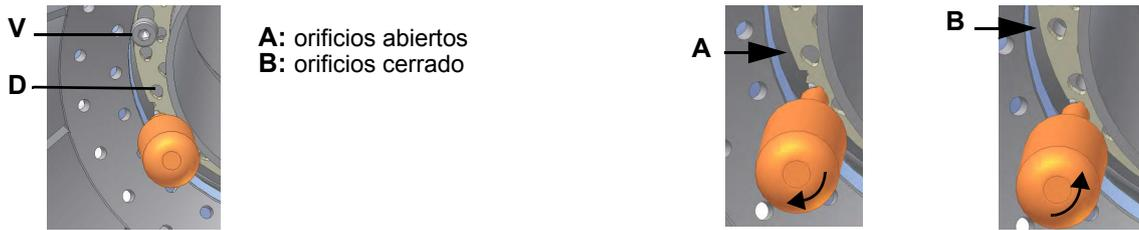
El disco se debe regular durante la puesta en funcionamiento de la instalación.
