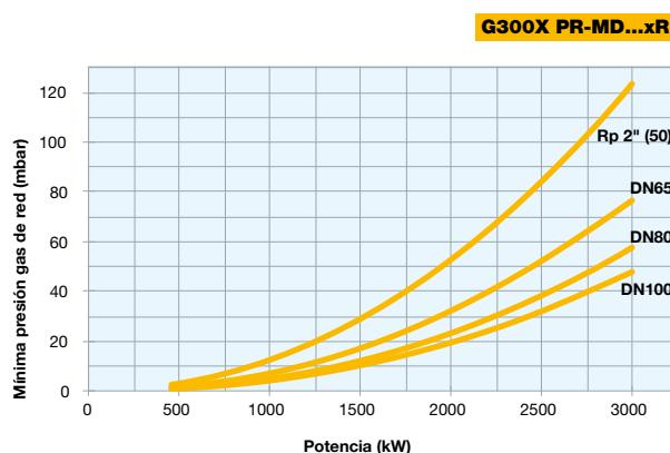
Atención: en horizontal está representado el valor de consumo de gas, en vertical esta representado el valor de la presión neta en red, sin la presión de la cámara de combustión. Para conocer la presión mínima en la rampa de gas, para obtener el caudal de gas necesario, debemos sumar la presión de la cámara de combustión al valor leído en la vertical.
