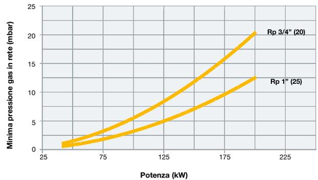
**Attenzione:** in ascissa è riportato il valore della potenza, in ordinata il corrispondente valore di pressione in rete al netto della pressione in camera di combustione. Per conoscere la pressione minima in ingresso rampa, necessaria per ottenere la portata gas richiesta, bisogna sommare la pressione in camera di combustione al valore letto in ordinata.
