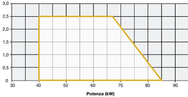
Contropressione in camera di combustione (mbar)
