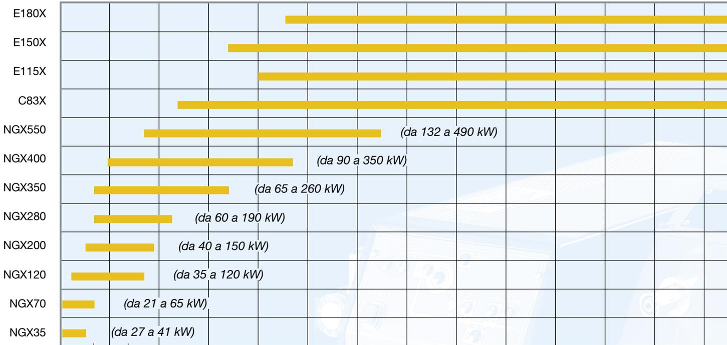
Questa nuova generazione di bruciatori della gamma IDEA **Low NO<sub>x</sub> Classe 3 (< 80 mg/kWh)**, è stata sviluppata e costruita per assicurare nelle applicazioni il più basso impatto ambientale possibile. L'innovativa testa di combustione consente di ottenere un equilibrato flusso dell'aria comburente tale da permettere alla fiamma di svilupparsi progressivamente ed armoniosamente per tutta la lunghezza della camera di combustione.
