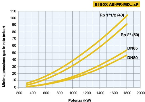
**Attenzione:** in ascissa è riportato il valore della potenza, in ordinata il corrispondente valore di pressione in rete al netto della pressione in camera di combustione. Per conoscere la pressione minima in ingresso rampa, necessaria per ottenere la portata gas richiesta, bisogna sommare la pressione in camera di combustione al valore letto in ordinata.
