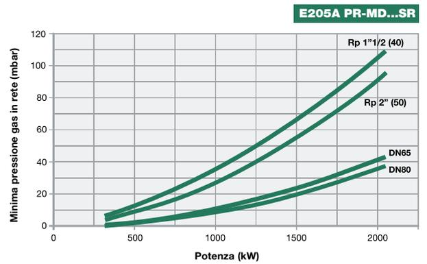
**Attenzione:** in ascissa è riportato il valore della potenza, in ordinata il corrispondente valore di pressione in rete al netto della pressione in camera di combustione. Per conoscere la pressione minima in ingresso rampa, necessaria per ottenere la portata gas richiesta, bisogna sommare la pressione in camera di combustione al valore letto in ordinata.
