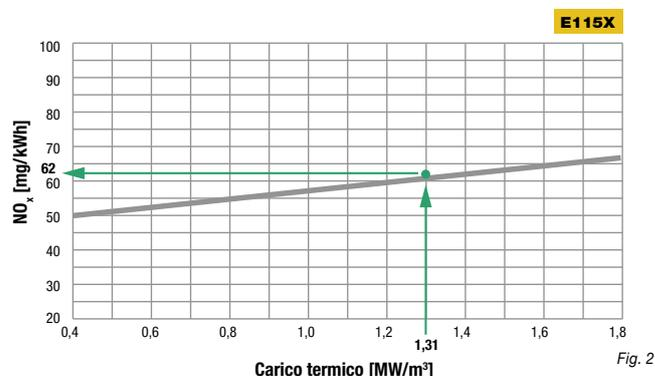
Nel diagramma carico termico - NO<sub>x</sub> (Fig. 2) del bruciatore selezionato, si individua il carico termico così calcolato, si traccia una linea verticale fino a incontrare la curva degli NO<sub>x</sub> e si legge il valore in ordinata.
