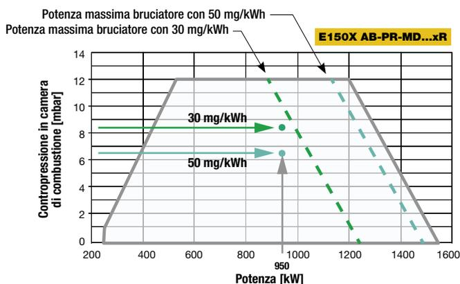
Il bruciatore E150X della selezione 2 è corretto, il punto di utilizzo è all'interno della curva di lavoro. Per questa ragione possiamo utilizzare questo modello per la nostra applicazione con le emissioni 50 e 30 mg/kWh.
