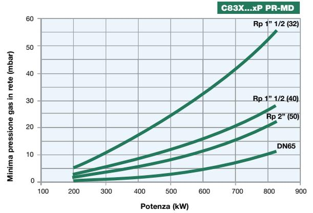
**Attenzione:** in ascissa è riportato il valore della potenza, in ordinata il corrispondente valore di pressione in rete al netto della pressione in camera di combustione. Per conoscere la pressione minima in ingresso rampa, necessaria per ottenere la portata gas richiesta, bisogna sommare la pressione in camera di combustione al valore letto in ordinata.
