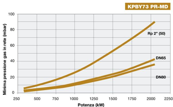
**Attenzione:** in ascissa è riportato il valore della potenza gas, in ordinata il corrispondente valore di pressione in rete al netto della pressione in camera di combustione. Per conoscere la pressione minima in ingresso rampa, necessaria per ottenere la portata gas richiesta, bisogna sommare la pressione in camera di combustione al valore letto in ordinata.
