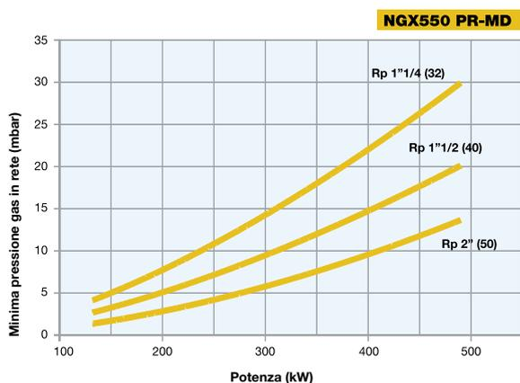
**Attenzione:** in ascissa è riportato il valore della potenza, in ordinata il corrispondente valore di pressione in rete al netto della pressione in camera di combustione. Per conoscere la pressione minima in ingresso rampa, necessaria per ottenere la portata gas richiesta, bisogna sommare la pressione in camera di combustione al valore letto in ordinata.
