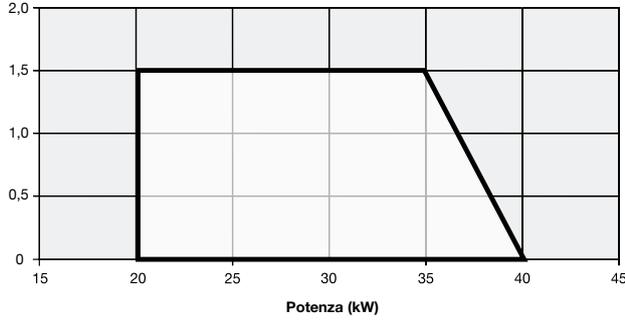
Contropressione in camera di combustione (mbar)
