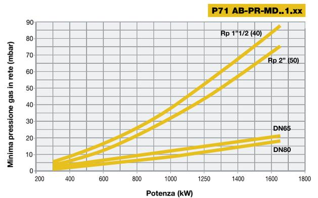
**Attenzione:** in ascissa è riportato il valore della potenza, in ordinata il corrispondente valore di pressione in rete al netto della pressione in camera di combustione. Per conoscere la pressione minima in ingresso rampa, necessaria per ottenere la portata gas richiesta, bisogna sommare la pressione in camera di combustione al valore letto in ordinata.
