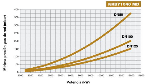
Atención: en horizontal está representado el valor de consumo de gas, en vertical está representado el valor de la presión neto en red, sin la presión de la cámara de combustión. Para conocer la presión mínima en la rampa de gas, para obtener el caudal de gas necesario, debemos sumar la presión de la cámara de combustión al valor leído en la vertical.
