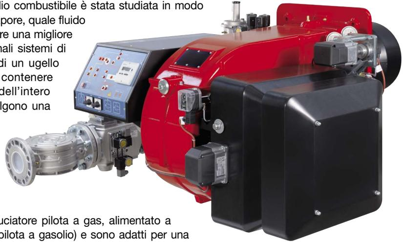
I bruciatori prevedono l'accensione a mezzo bruciatore pilota a gas, alimentato a metano oppure a GPL (su richiesta, disponibile pilota a gasolio) e sono adatti per una viscosità fino a 4.000 cSt a 50°C (530°E a 50°C). Il bruciatore standard è previsto solo per la polverizzazione ad aria compressa. Nel caso si scelga di utilizzare il vapore quale fluido di atomizzazione, il bruciatore viene modificato con uno specifico kit.
