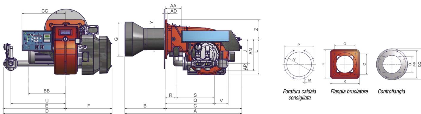
I preriscaldatori sono inclusi nella fornitura, in un supporto separato. Il gruppo spinta motore e pompa di bassa pressione è incluso nella fornitura, ma fornito separato (non a bordo).
