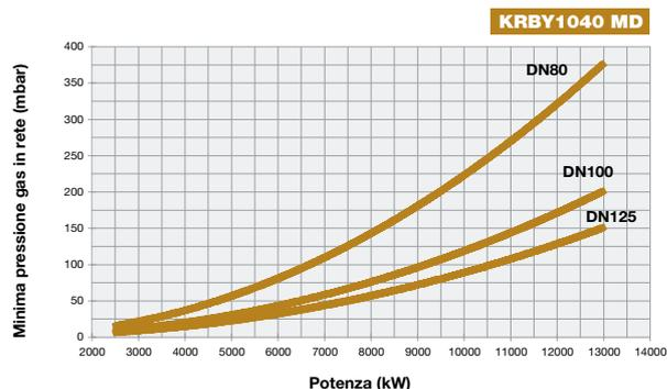
**Attenzione:** in ascissa è riportato il valore della potenza gas, in ordinata il corrispondente valore di pressione in rete al netto della pressione in camera di combustione. Per conoscere la pressione minima in ingresso rampa, necessaria per ottenere la portata gas richiesta, bisogna sommare la pressione in camera di combustione al valore letto in ordinata.
