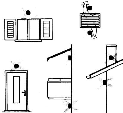
Evitare montaggi in prossimità di finestre, griglie di areazione, all'esterno del locale caldaia, sui camini o protetta da balconi, tettoie.
