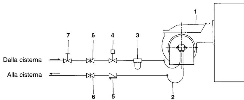
Fig. 11 - Sistema bitubo
