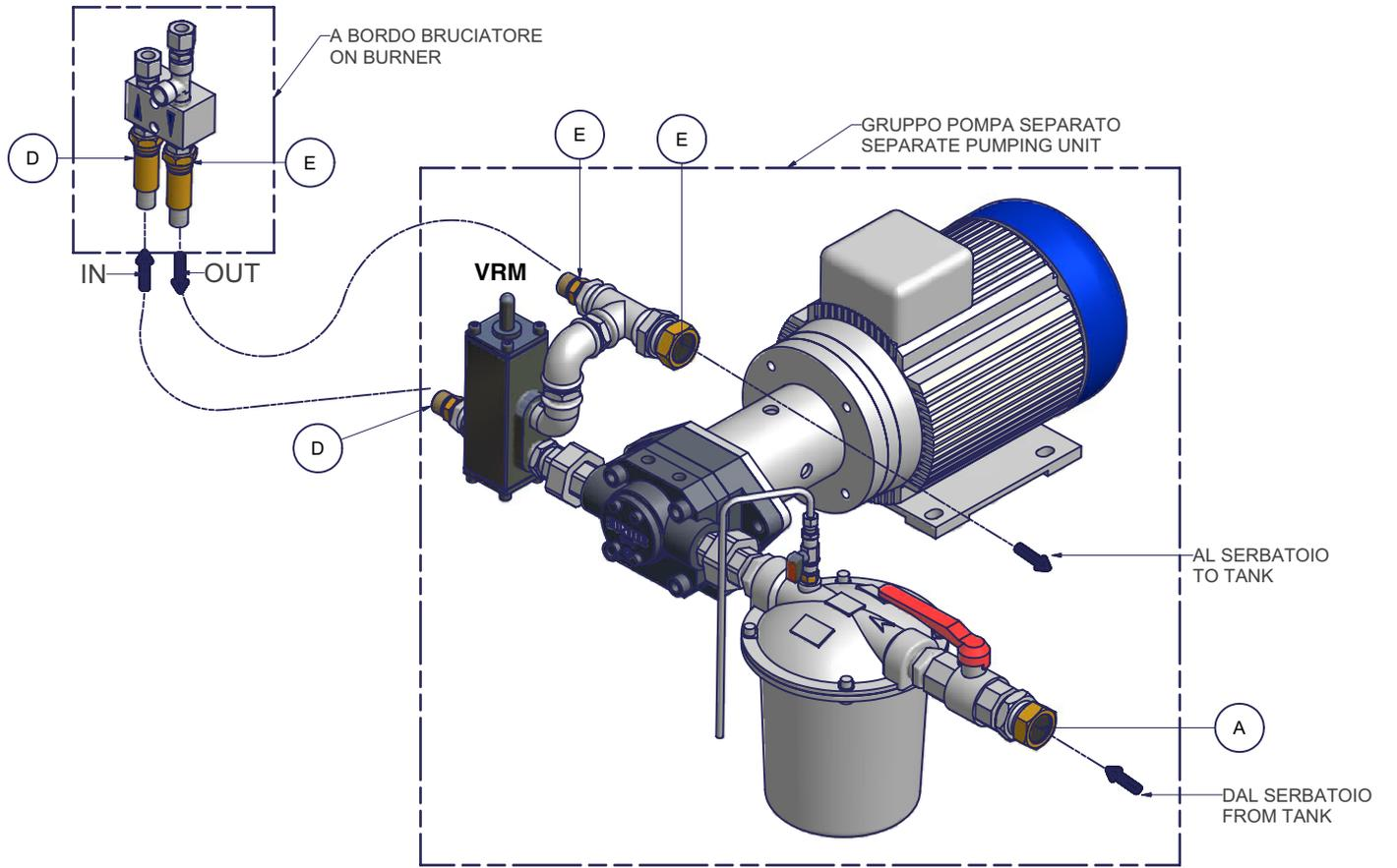
**ATTENZIONE:** i tappi di plastica non sono a tenuta ma servono solamente per il trasporto. I flessibili, tra pompa e bruciatore, sono quelli indicati in etichetta come "Flessibile alta pressione olio". Il flessibile indicato come "Flessibile bassa pressione" in etichetta, va collegato a monte filtro.
