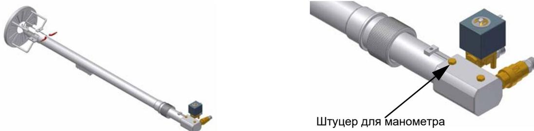
Рис. 15 - Голова сгорания с фурмой дизтоплива (PG70 - PG81)
