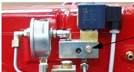
Рис. 14 - Распределительный блок дизтоплива (PG60)
