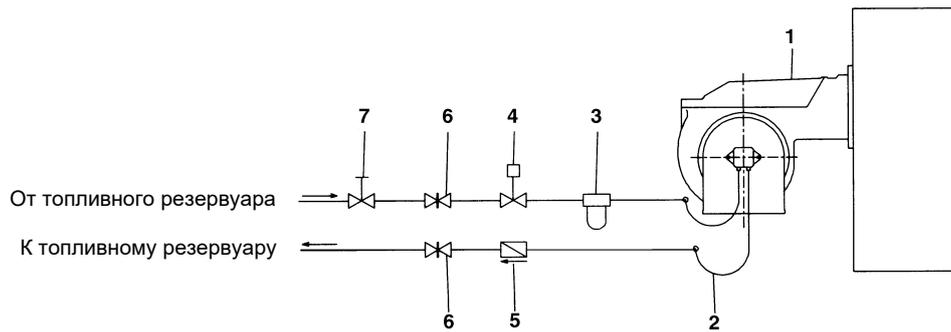
Рис. 5 - Двухтрубная система
