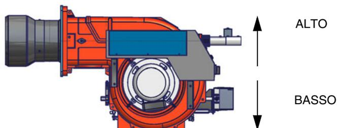
**Montaggio del bruciatore alla caldaia**
