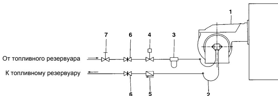
Рис. 6 - Двухтрубная система
