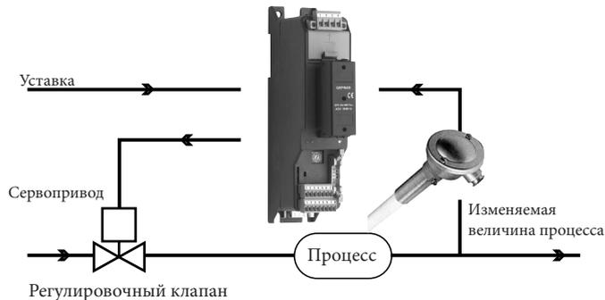
ПРИМЕР УПРАВЛЕНИЯ ДЛЯ КЛАПАНА V0
