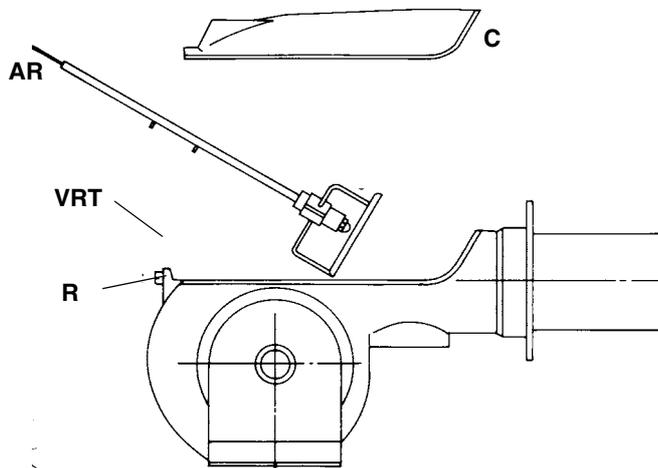
**Снятие головки сгорания**
