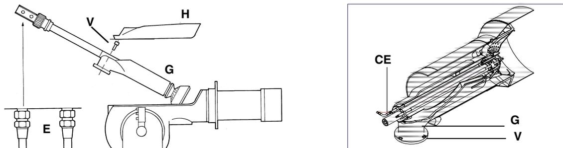
**Estrazione della lancia, sostituzione dell'ugello e degli elettrodi**
