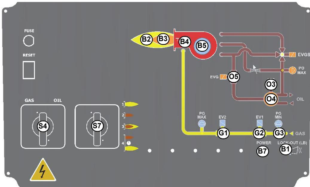
Fig. 7 - Pannello frontale quadro elettrico bruciatore
