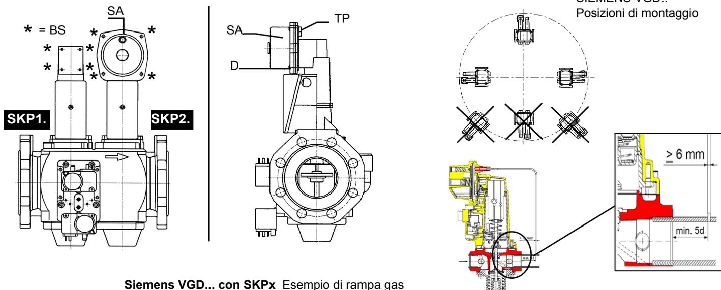
Siemens VGD... con SKPx Esempio di rampa gas
